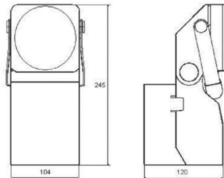
Bild 4: Abmessung AccuLux SL 5 LED/AccuLux SL 6 LED, Typ 456x41
